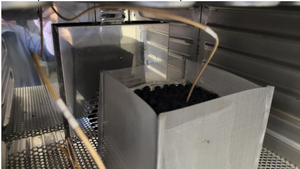
Figur 2: Test opsætning til evaluering af hvorvidt biokul er selvopvarmende.
