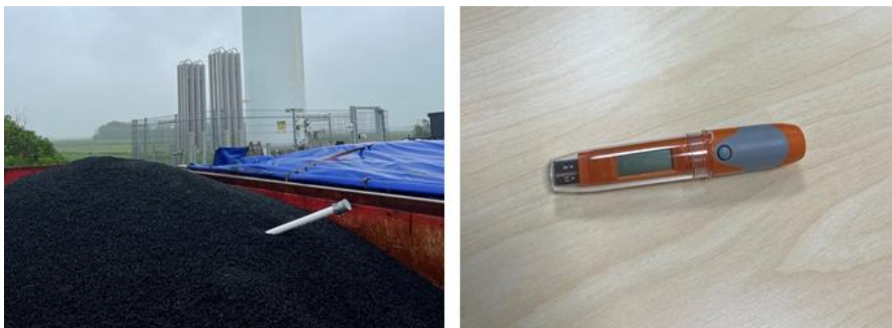
Figur 4: Opbevaringsforsøg med temperatur logger. Loggeren er stukket ind i midten af stakken i et PVC rør.
